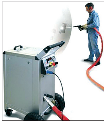
Sowohl mobil beim Kunden als auch stationär in der Firmenzentrale der Andreas Gerwin Oberflächentechnik ist die Trockeneisstrahlung zur Reinigung von Oberflächen einsetzbar.
