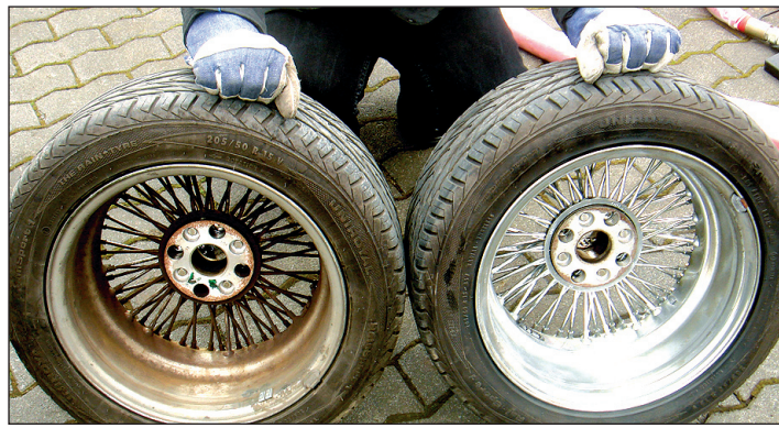
Ein Unterschied wie Tag und Nacht: Diese Felgen eines Oldtimer sehen nach der Reinigung mit Trockeneisstrahlen wieder wie neu aus. Der Felge ist deutlich anzusehen, dass die Oberfläche nicht zerkratzt wurde, sondern wieder blitzblank glänzt. Fotos (2): al
